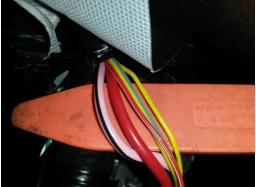
Провода разъема замка зажигания
