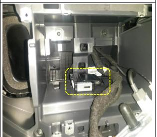
Для крепления блока системы используйте пластиковые хомуты-стяжки и двусторонний скотч. Блок системы должен быть жестко закреплен, во избежание перемещений и биения корпуса блока во время движения автомобиля, а также для корректной регулировки и работы датчика перемещения/наклона/ ускорения.
