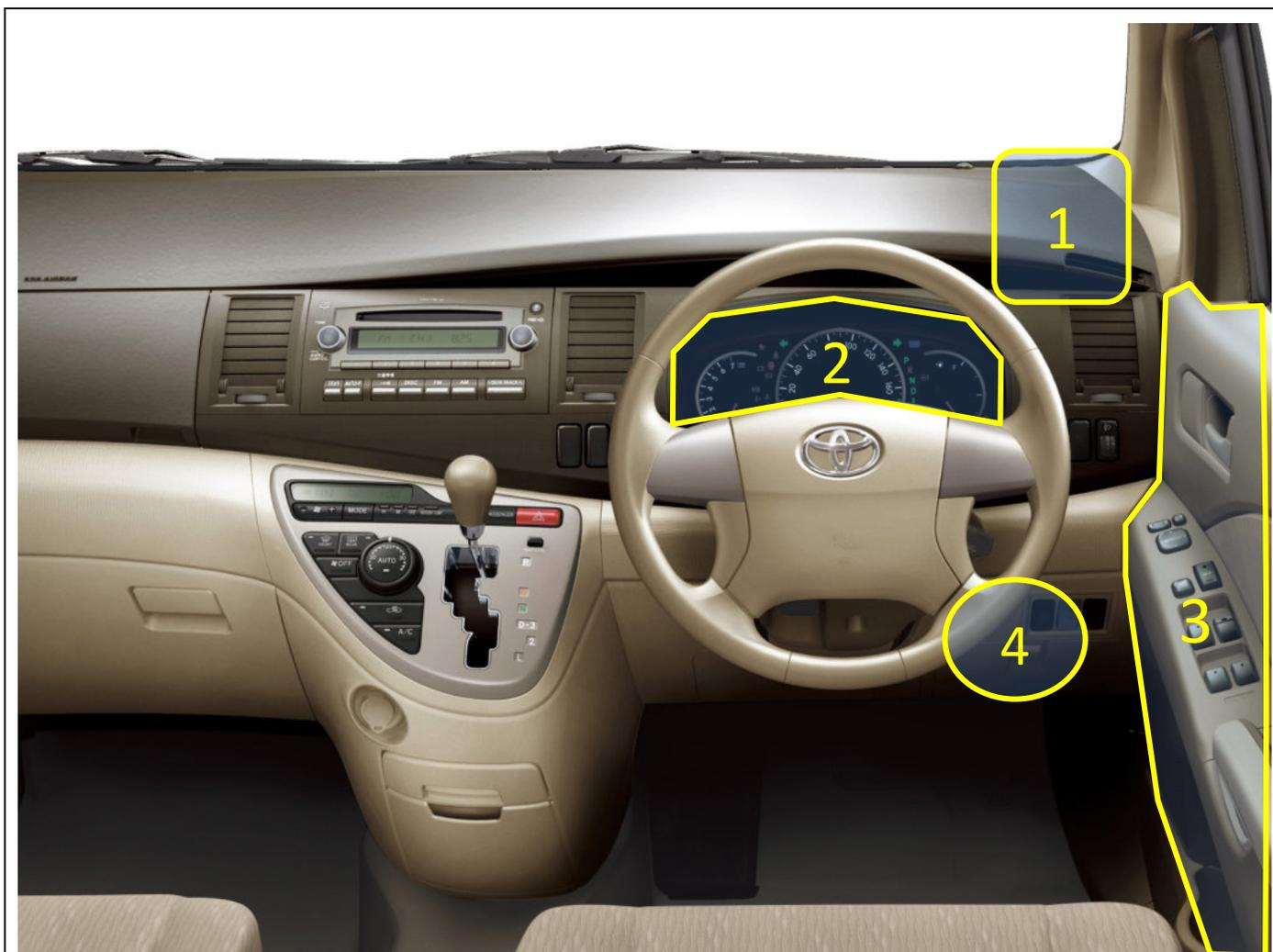
1. Расположение Блоков iCode Vox, Power Management и Start/Smart справа возле водительской стойки. На этих блоках осуществляется обход штатного иммобилайзера и реализация автоматического запуска двигателя.
