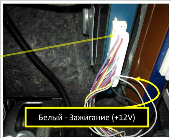
Подключение силовых цепей зажигания
