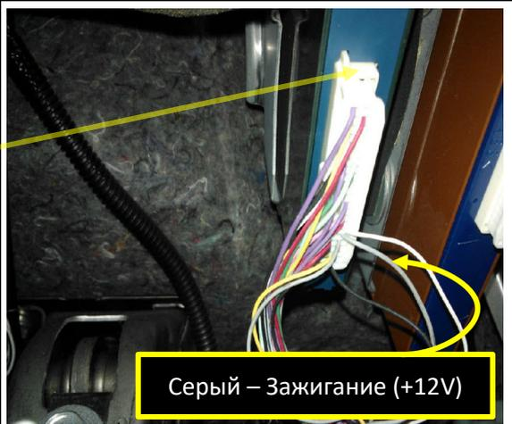
Подключение силовых цепей зажигания
