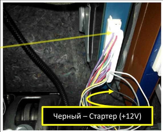
Подключение силовых цепей зажигания
