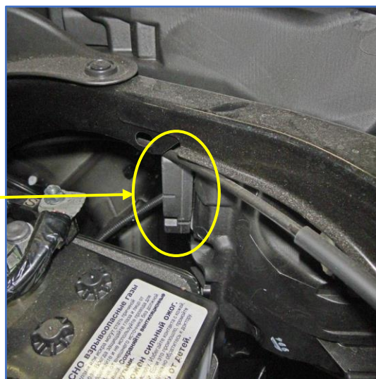
Рис. 19.2. Возможное место размещения пьезосирены Pandora PS-330
