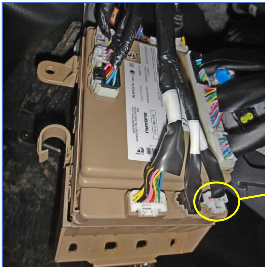
Рис. 15.1. Разъём g (белый) с обратной стороны ЦБУ
