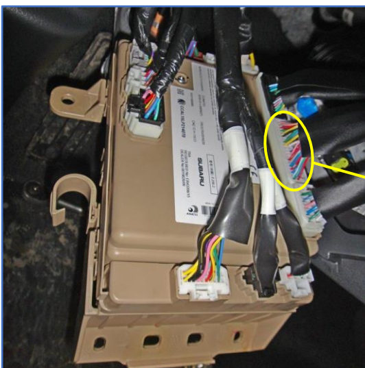
Рис. 12.3. Разъём k (белый) с обратной стороны ЦБУ
