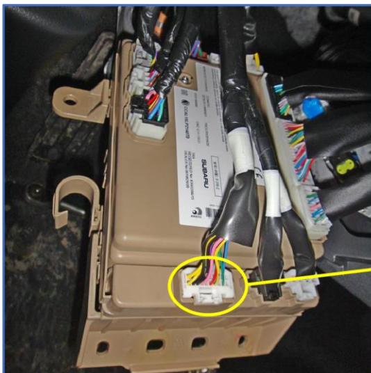
Рис. 14.1. Разъём i (белый) с обратной стороны ЦБУ
