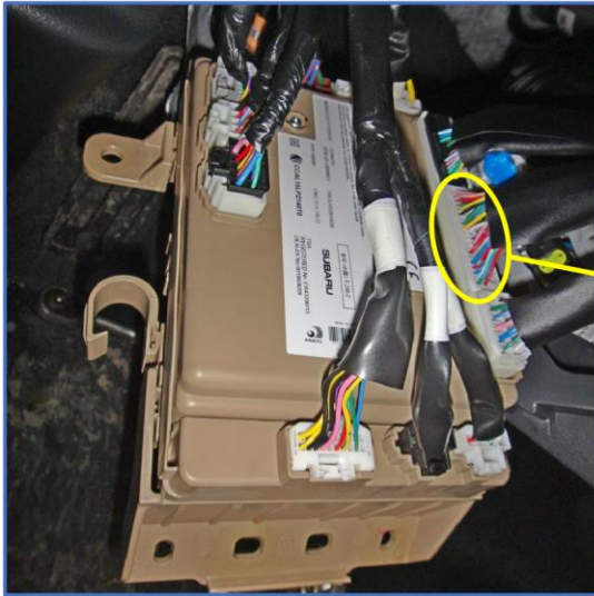
Рис. 12.5. Разъём k (белый) с обратной стороны ЦБУ
