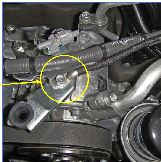
Рис. 18.2. Возможное место размещения датчика температуры
