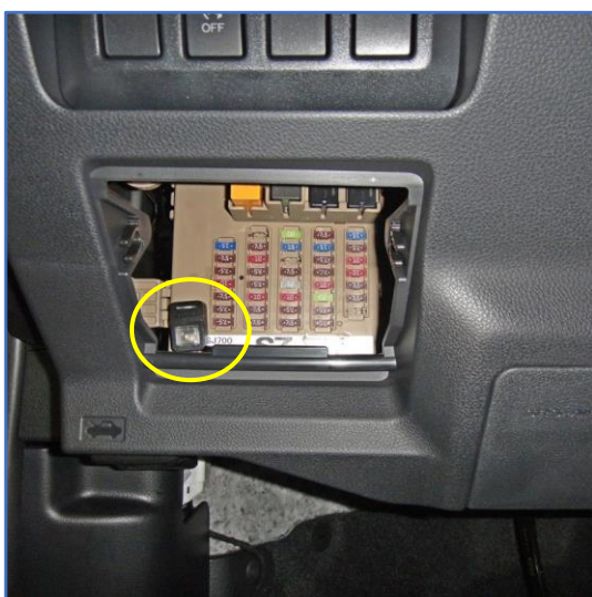
Рис. 17. Возможное место размещения кнопки «VALET»
