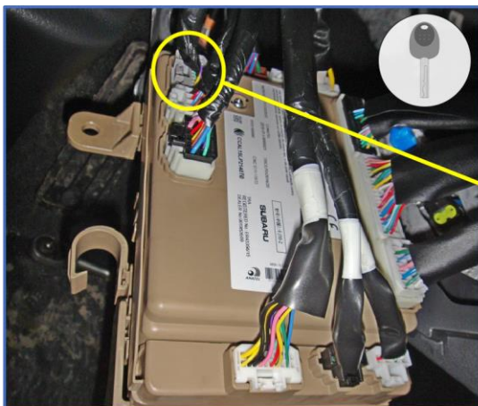
Рис. 13.1. Разъём q (серый) с обратной стороны ЦБУ
