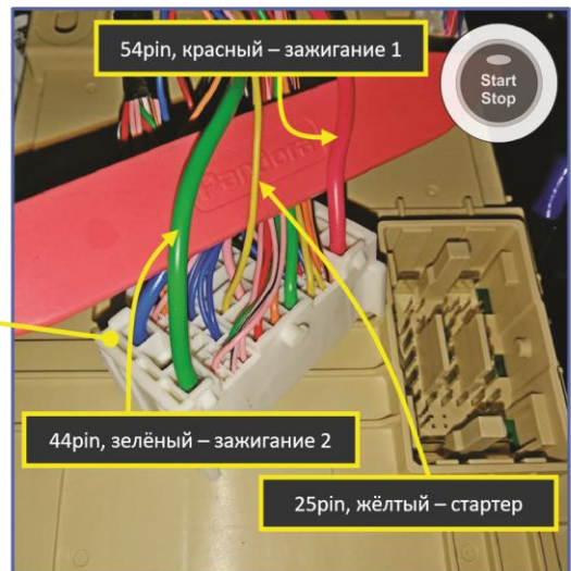
Рис. 12.2. Разъём ICU-E с обратной стороны блока предохранителей на автомобилях с кнопкой Start Stop
