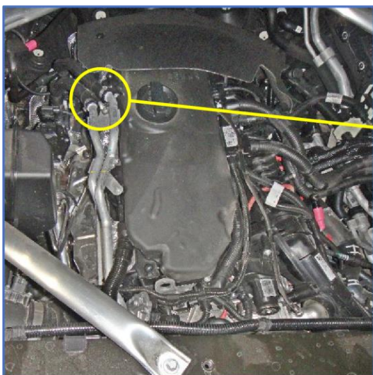
Рис. 17.1. Возможное место размещения датчика температуры двигателя (для двигателя 30d)
