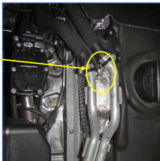
Рис. 17.2. Возможное место размещения датчика температуры двигателя (для двигателя 30d)
