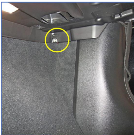
Рис. 16. Возможное место размещения кнопки «VALET»
