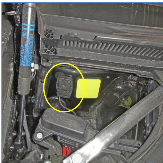
Рис.18.1 Возможное место размещения сирены
