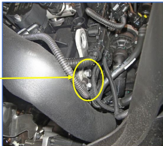
Рис. 17.4. Возможное место размещения датчика температуры двигателя (для двигателя 20i)
