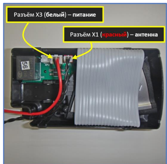
Рис. 15.2. Размещение ключа в обходчике иммобилайзера.
