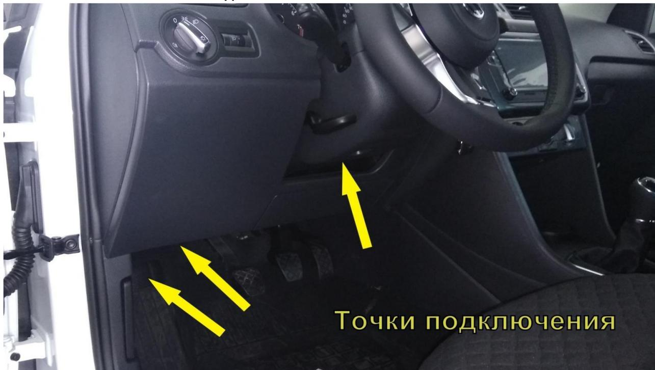
Часть подключений выполняется на разъемах блока VCM под приборной панелью.
