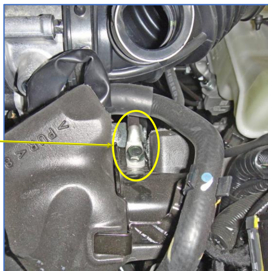
Рис. 9.1 и 9.2. Возможное место размещения датчика температуры (для бензинового двигателя)
