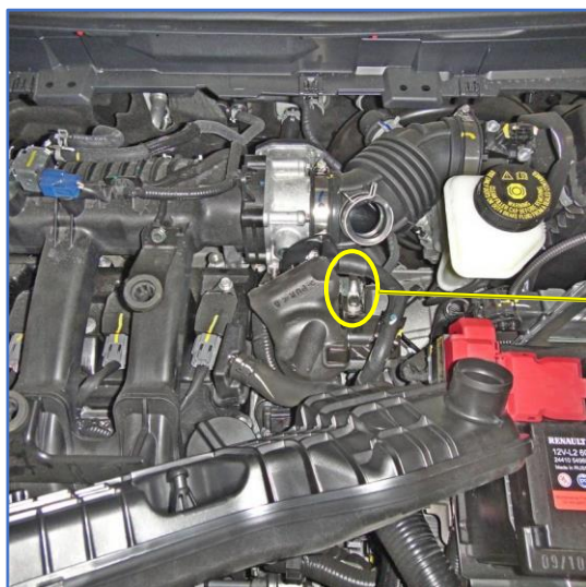
Рис. 9.1 и 9.2. Возможное место размещения датчика температуры (для бензинового двигателя)
