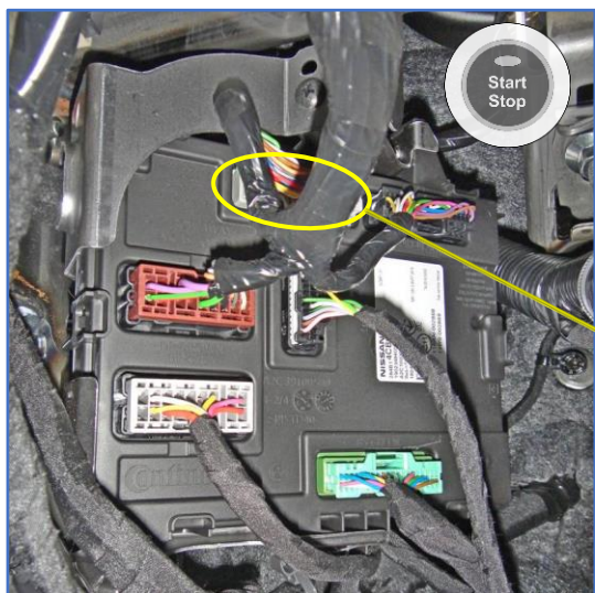
Рис. 4.1 и 4.2. Разъём M87 (серый) блока BCM
