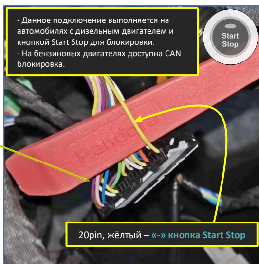
Рис. 6.1 и 6.2. Разъём M88 (чёрный) блока BCM
