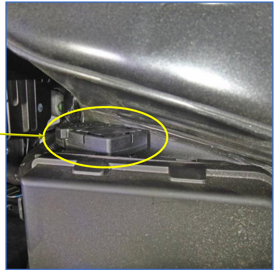
Рис. 10.1 и 10.2. Возможное место размещения сирены
