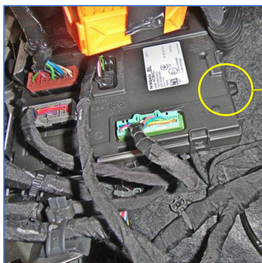
Рис. 2.1 и 2.2. Расположение базового блока
