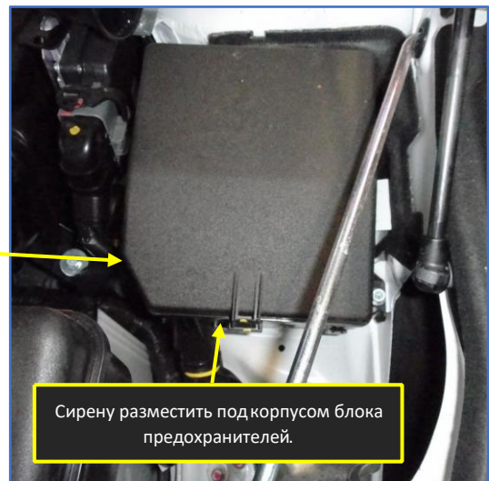
Рис. 17.2. Возможное место размещения пьезосирены Pandora PS-330
