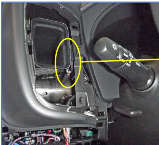
Рис. 9.1. Расположение базового блока
