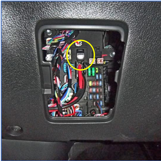
Рис. 15. Возможное место размещения кнопки «VALET»
