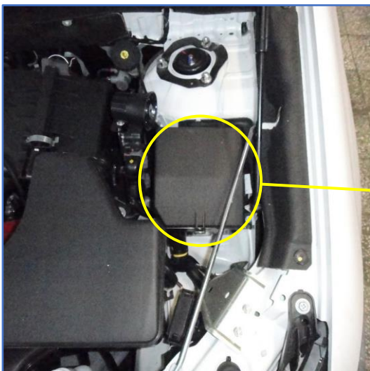
Рис. 17.1. Возможное место размещения пьезосирены Pandora PS-330
