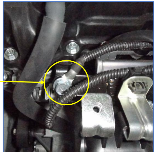
Рис. 16.2. Возможное место размещения датчика температуры
