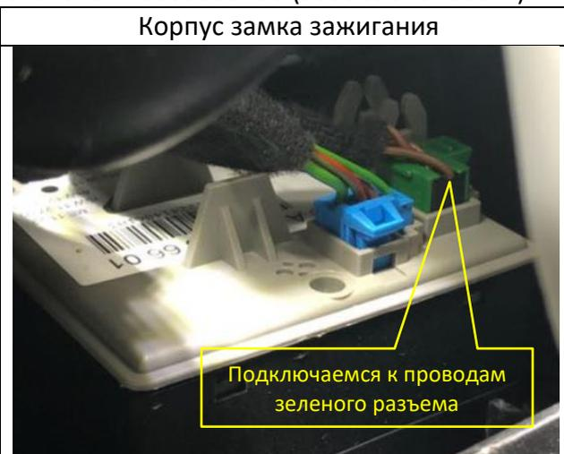
Корпус замка зажигания
